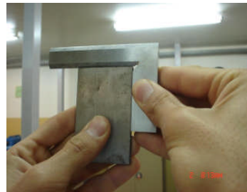
Şekil 1.10: Gönye ile yüzey kontrolü
