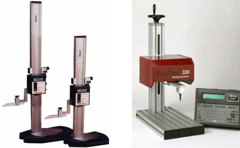
Şekil 2.1: Mihengir ve elektronik kontrollü markalama cihazı
