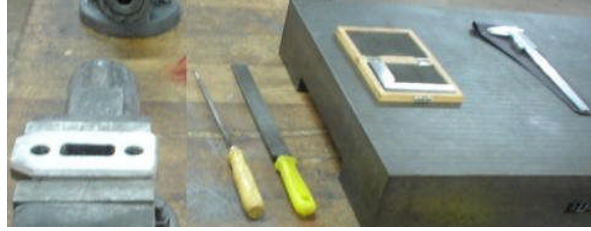
Şekil 1.6: Mengene ile ölçü-kontrol aletlerinin ve eğelerin düzeni
