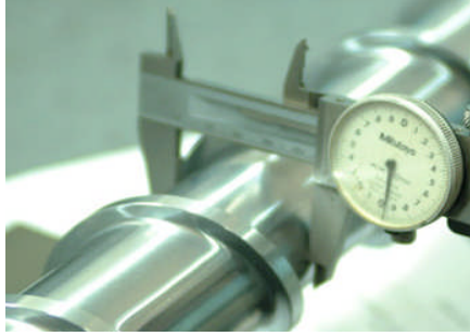
Şekil 2.4: Saatli kumpas ile ölçme
