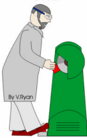
Şekil 1.5 : Taşta DOĞRU çalışma şekli
