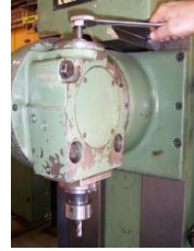
Resim 2.11: Malafa milinin fener miline takılması
