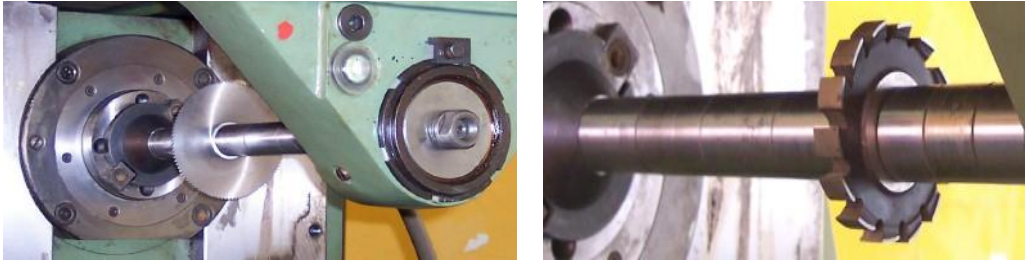
Resim 7.2: Tezgâha bağlanmış kanal çakısı
