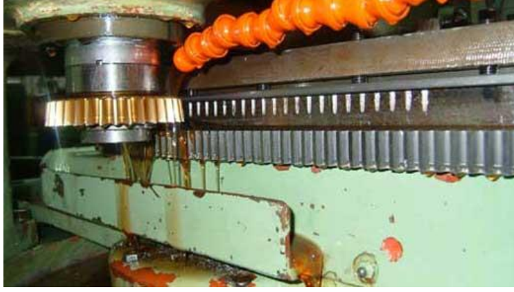
Resim Hata! Belgede belirtilen stilde metne rastlanmadı..10: Pinyon bıçakla diş açılması
