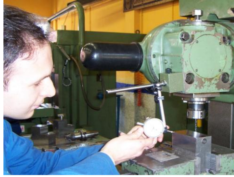
Resim 7.1a: Mengenenin tablaya komparatörle paralel hâle getirilmesi
