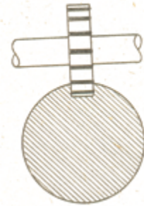
Şekil 7.8: Mile kanal açılması
