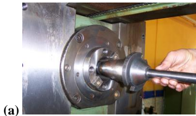
Resim 2.11: Malafa milinin fener miline takılması
