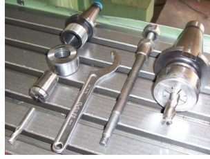
Resim 7.6: Pens tertibatının freze dik başlığına ektilmesi
