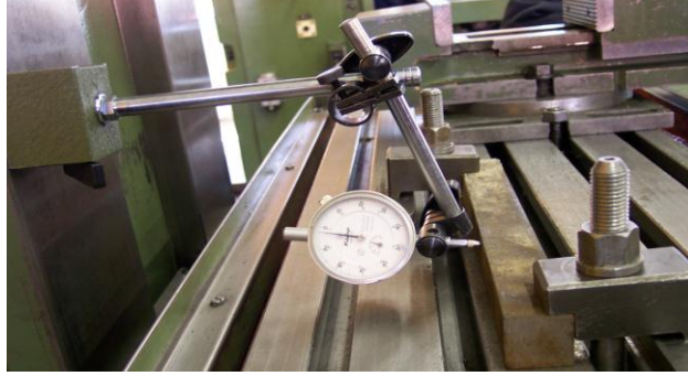
Resim 3.4: Komparatörle iş parçasının gövdeye paralel bağlama
