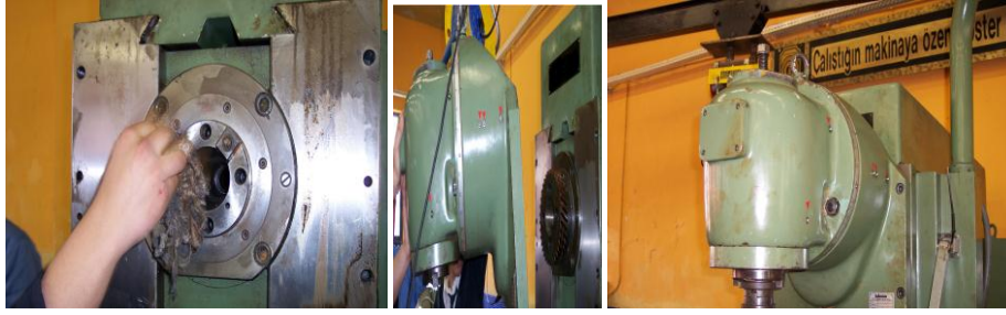
Resim 2.21: Dik başlığın tezgâha takılması
