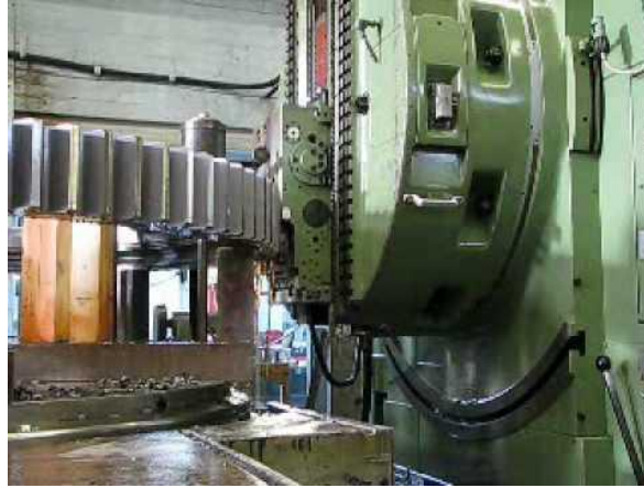
Resim Hata! Belgede belirtilen stilde metne rastlanmadı..11: Kramayer biçimli bıçakla diş açma
