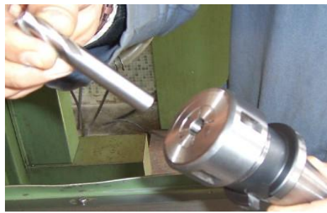
Resim 7.7: Pens tertibatının montajı ve parmak frezenin takılışı
