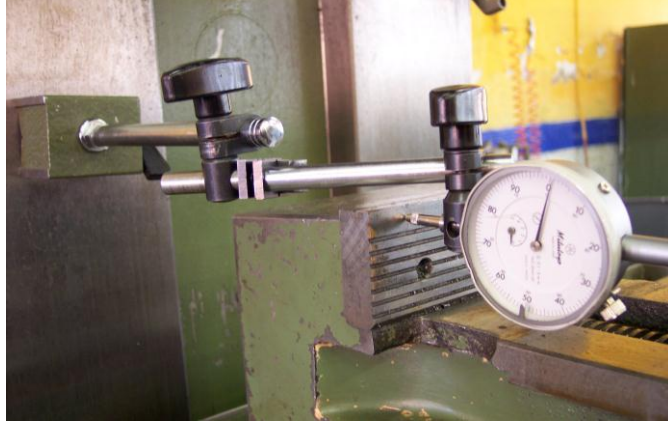
Resim 3.1: Mengene ağızlarının komparatörle gövdeye paralellik ve diklik kontrolü
