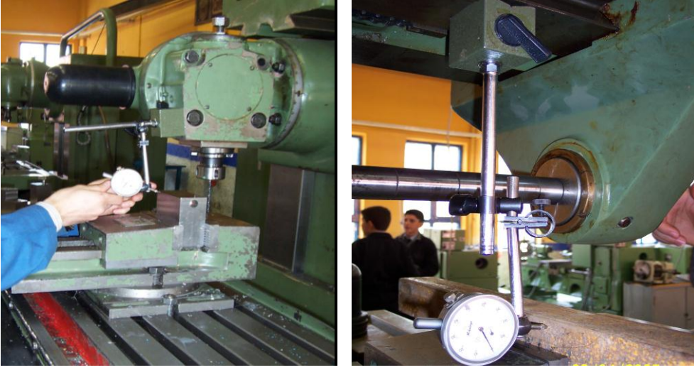
Resim 4.9: İş parçasının komparatörle kontrolü
