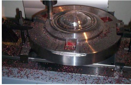
Resim 3.5: İş parçasını cıvata ve pabuçlarla bağlama
