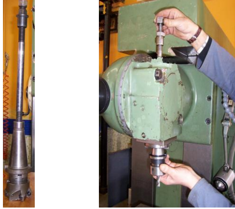
Resim 2.16: Kısa malafa mili ve u vidasının dik bařlıđa takılıřı
