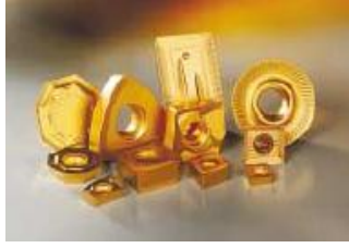
a) Tungsten karbür sert maden kesici uçlar
