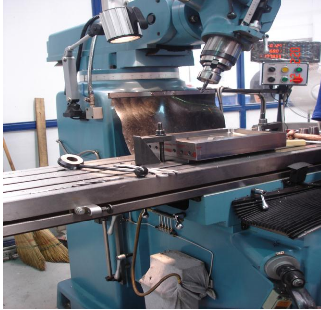
Resim 3.6: İş parçasının cıvata ve pabuçlarla bağlanması
