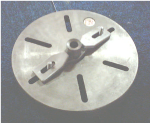
Resim 3.8: Bir İş Parçasının Bağlama Kalıbı İle Delikli aynaya bağlanması
