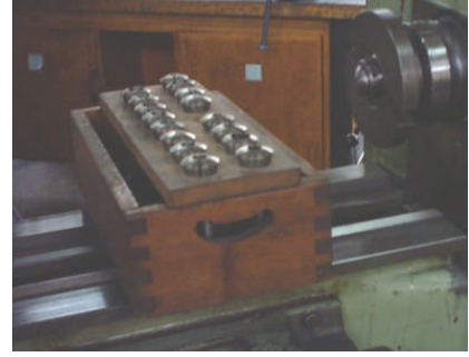
Resim 3.7: Değişik Çaplardaki Pensler ve Tornaya Bağlanması
