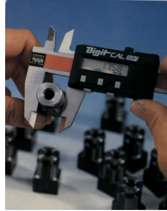
Resim 5.4: Dijital Kumpasla Dış Ölçüm Yapılması
