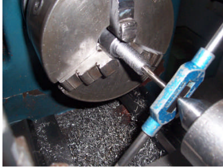
Resim4.4: Kılavuzun Parçaya Ağızlatılması
