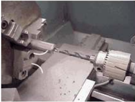
Silindirik matkap ile delik delmek
